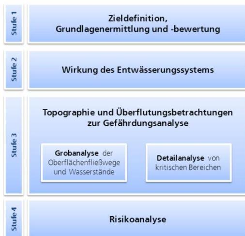
Bild 4: Stufenkonzept zur Erstellung einer urbanen Gefahrenkarte in Anlehnung an LANUV (2010b) und LANUV (2012)
